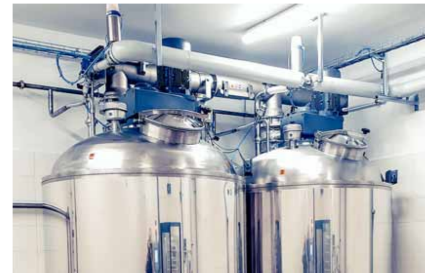
Δεξαμενές παραγωγής προζυμιών με αυτοματισμούς και σύστημα CIP
